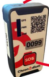
➔ **APPUYEZ 3"** sur le bouton supérieur jusqu'à ce que le **VOYANT "PWR" ROUGE** apparaisse pour **l'ALLUMER**.
